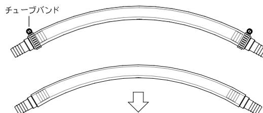
③ ポンプにセットする際は、チューブの癖がローラーにはうようにチューブホルダーにセットして下さい。
