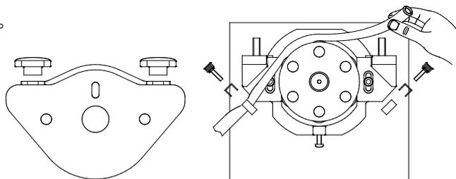
③ 交換するチューブをローラーに這わせ、チューブ押えの溝にチューブを置きます。
