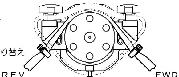
⑤運転スイッチを「STAND-BY」から「RUN」に切り替えると、設定した回転数でローラーが回転します。
