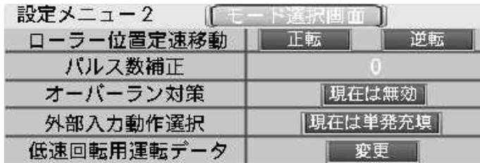
ローラー位置定速移動・・・ローラーの位置を調整する機能です。(低回転で回転します)
