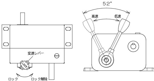
②変速レバーを右に倒すと低速回転、左に倒すと
